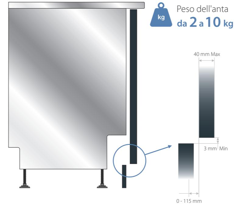
Le cerniere sliding sono state sviluppate per differenti pesi e spessori del pannello. Il peso dell'anta può variare da 2 a 10 kg, e lo spessore da 16 a 40 mm.
